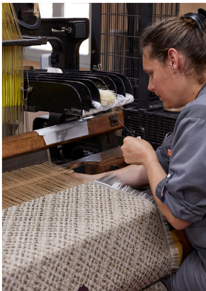
Tissage d'une étoffe de crin de cheval sur un métier à tisser dans la Manufacture du Crin à Challes © Métaphores - Le Crin/ Gaëlle Le Boulicaut, 2022
